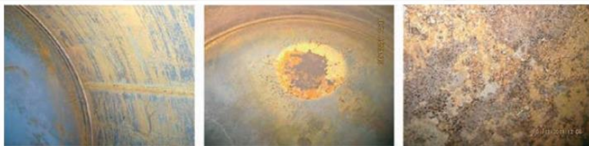
شکل ۴: ردیابی خوردگی در مخازن LPG با آزمون آکوستیک امیشن
