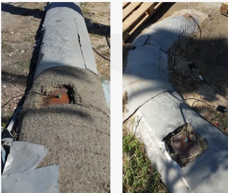
شکل ۲. سنسورهای AE نصب شده در امتداد لوله‌های عایق شده.
