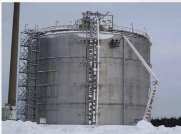
شکل ۳: سیستم مانیتورینگ مخازن LPG با آزمون آکوستیک امیشن در روسیه ۱۹۹۳
