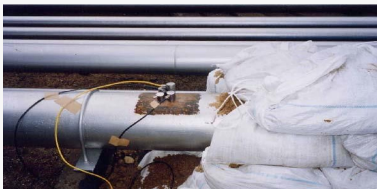
شکل ۵: سنسورهای AE بر روی یک لوله مدفون شبیه سازی.
