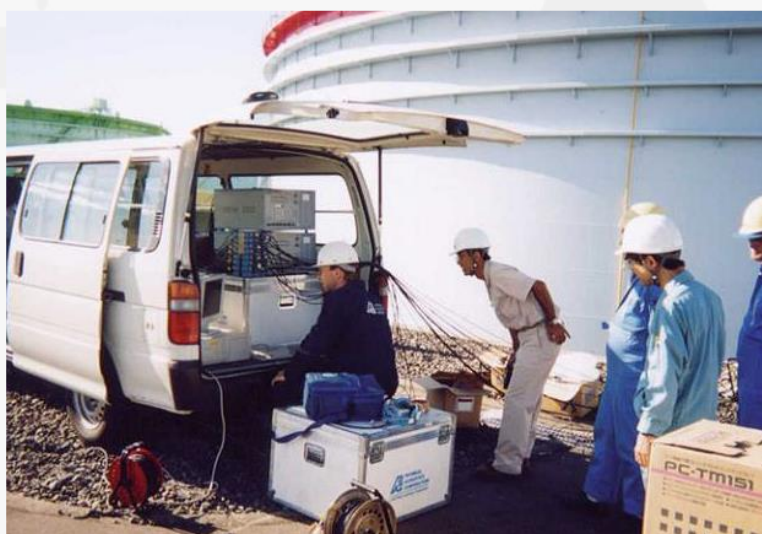
ردیابی خوردگی و نشتی در کف مخازن
