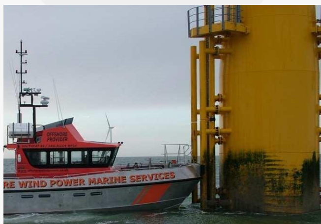
شکل ۳. یک قایق خدماتی در یک توربین بادی دریایی که دارای پایه خوردگی است.
