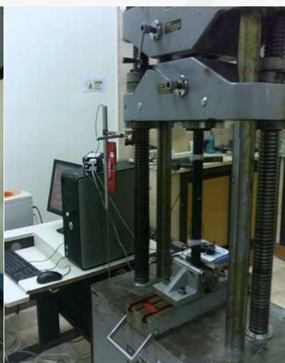
شکل ۳ عضو SHS برای تست کشش نصب شده است.
